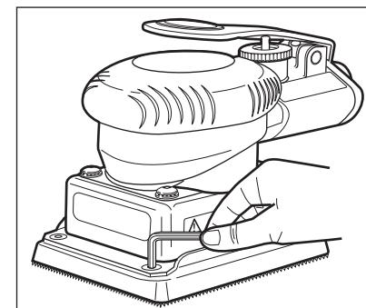
①下記の図のように六角レンチで4箇所のスクリュウを緩めて、シューよりパッドを外してください。
